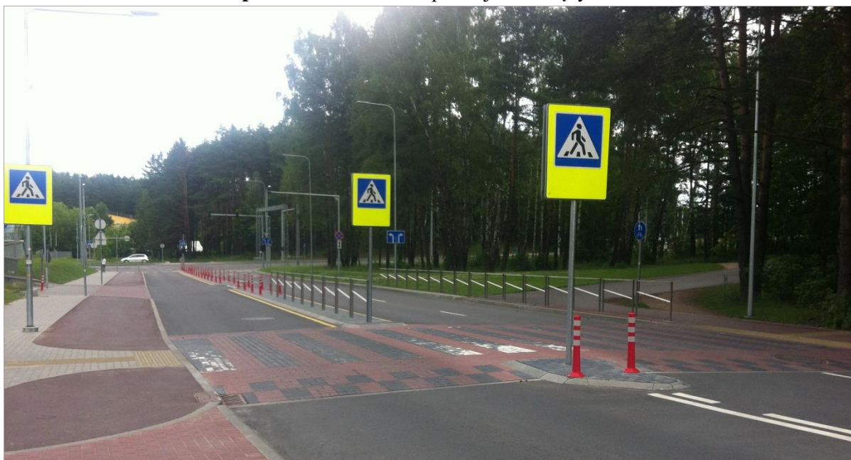
4.13 pav. Geroji praktika: pėsčiųjų perėja su inžineriniais saugumo elementais
