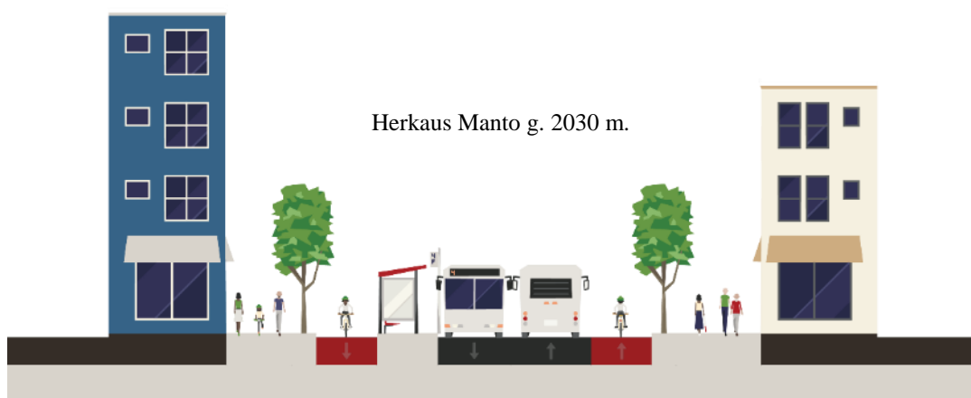
31 pav. Vizijoje Herkaus Manto gatvėje yra mažiau eismo juostų, lieka tik atskiros juostos greitajam viešajam transportui (fiziškai atskirtiems greitiesiems autobusams arba moderniajam tramvajui). Siūlome iškelti automobilius iš Herkaus Manto gatvės į kitas aplinkines gatves ir taip turėti atskirtas dviračių juostas bei plačius ir patogius šaligatvius. Toks pokytis žymiai pagerintų šios miesto arterijos patrauklumą. Šaltinis: sukurta naudojantis Streetmix.net
