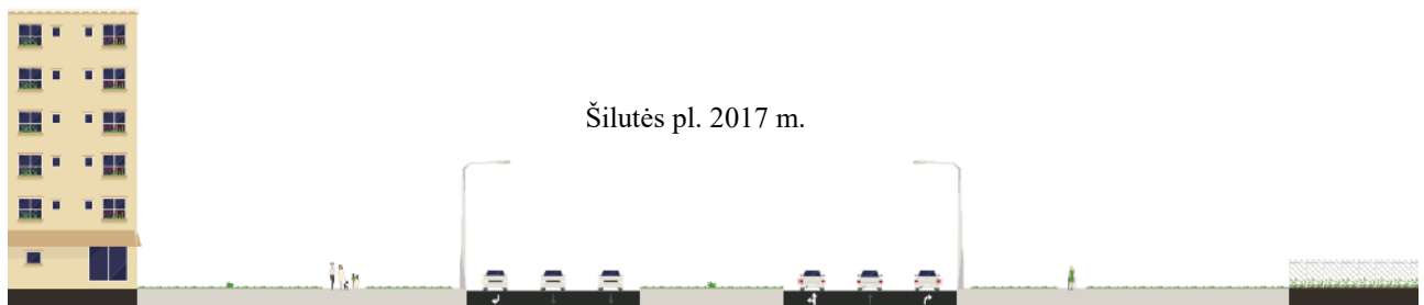
36 pav. Šilutės plentas – intensyvi miesto gatvė, su plačia važiuojamąja dalimi. Gatvėje yra įrengti šaligatviai, želdiniai, tačiau gatvė vis tiek yra gana „nedraugiška“ bevarikliam transportui. Šaltinis: sukurta autorių naudojantis Streetmix.net
