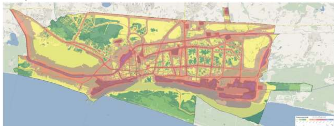
5 pav. Suminis (kelių transporto, geležinkelio transporto ir pramonins veiklos) strateginis triukšmo žemėlapis 2011 m. duomenimis
