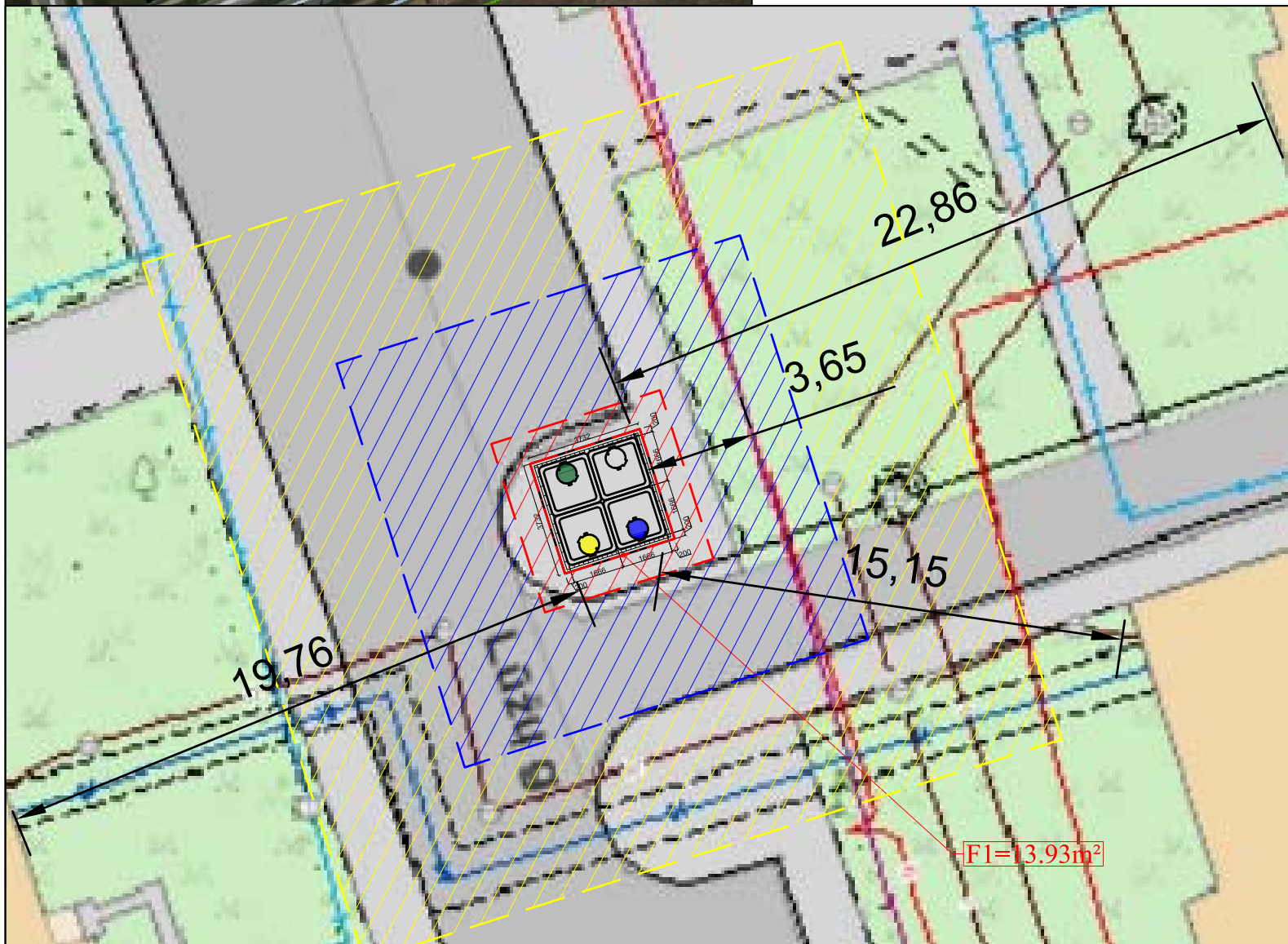
PUSIAU POŽEMINIŲ KONTEINERIŲ AIKŠTELĖS ĮRENGIMO SCHEMA M 1:200
