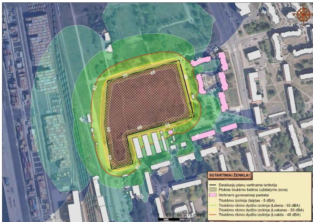
6.2.9.4 pav. Sąlyginės triukšmo sklaidos rezultatai ( L_{diena} , L_{vakaras} , L_{naktis} ) DPL planuojamoje teritorijoje pagal koncepciją Nr. 1 (netaikant poveikio mažinimo priemonių)
