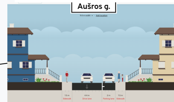
Preliminarus Aušros g. skersinis profilis, numačius vienpusį eismą ir leidžiant stovėti TP vienoje gatvės pusėje
