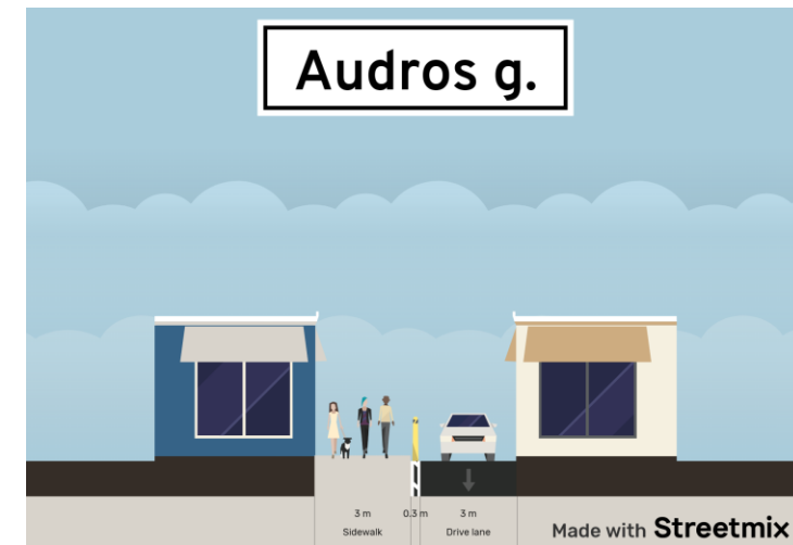
Preliminarus Audros g. skersinis profilis, numačius vienpusį eismą bei pėsčiųjų ir dviračių zoną
