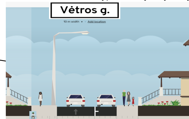
Preliminarus Vėtros g. skersinis profilis, numačius vienpusį eismą, leidžiant stovėti TP vienoje gatvės pusėje
