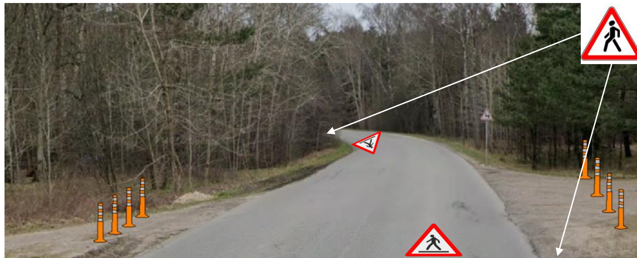
Horizontalus ženklimas, signaliniai stulpeliai ir kelio ženklai
