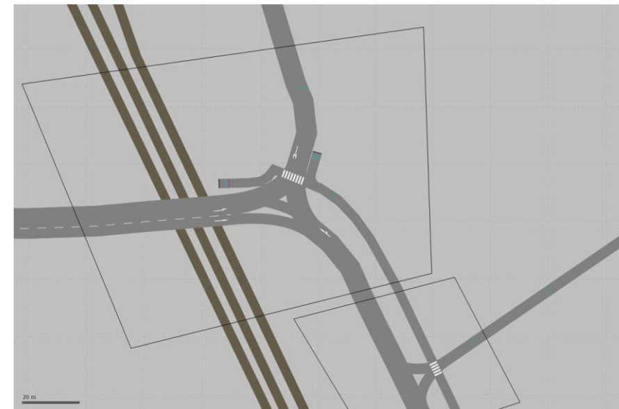
Eismo organizavimo schemos Nr. 2 (papildoma eismo juosta) eismo organizavimo modelio simuliacijos nuotrauka PTV Vissim programoje
