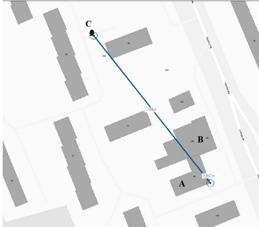
1 pav. Atstumas nuo artimiausio priešgaisrinio hidranto iki esamo ir projektuojamo pastato. A – esamas 9 aukštų daugiabutis, B- esamas 2 a. pastatas, C – priešgaisrinis hidrantas
