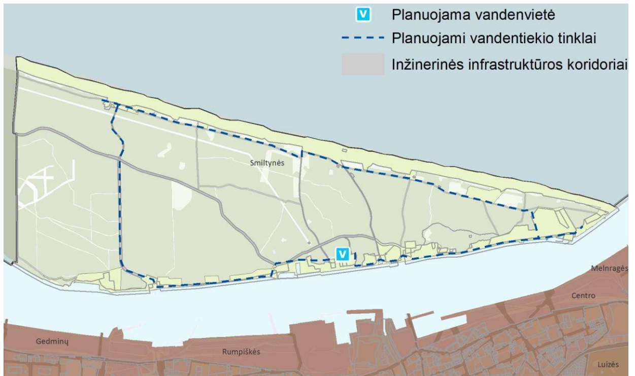
2 pav. Centralizuoto vandentiekio infrastruktūros alternatyva Smiltynės rajone
