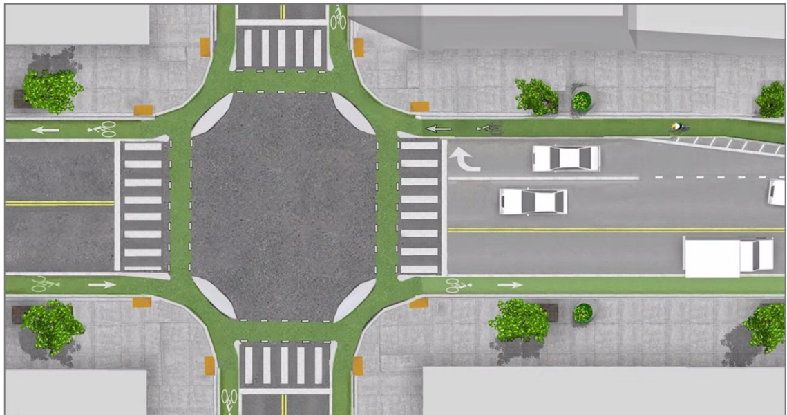
2.61 pav. „Olandiškos“ sankryžos planas (ilustracija - [8])
