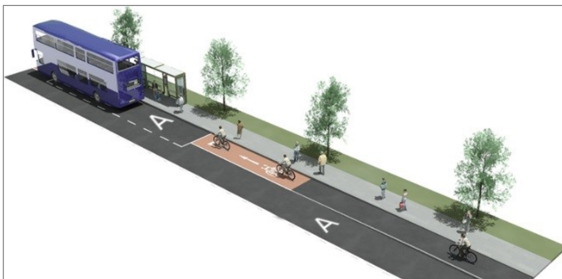
2.11 pav. Autobuso sustojimo zona dviračių juostoje
