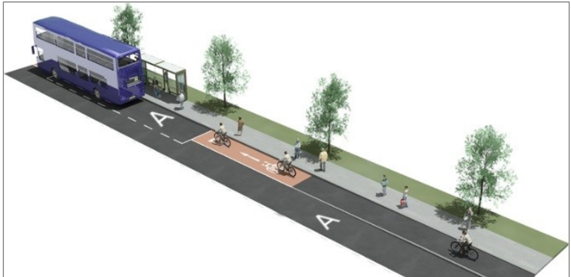
2.12 pav. Autobuso sustojimo zona dviračių juostoje
