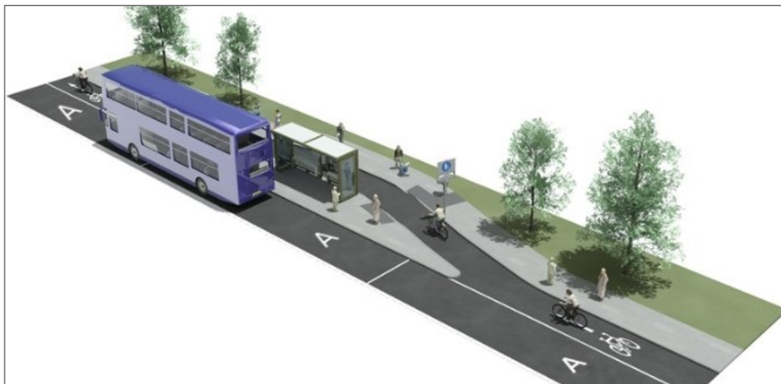
2.11 pav. Viešojo transporto stotelės aplenkimas už laukimo paviljono
