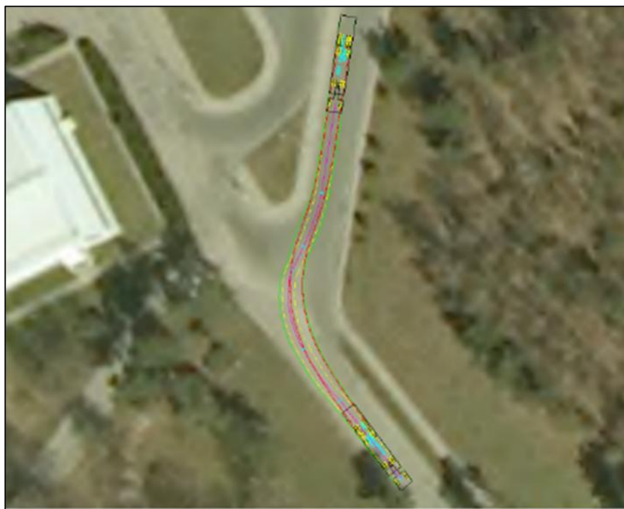
4.3 pav. 1 sankryžos pravažumo tyrimas (atvažiuojant į SGGT)
