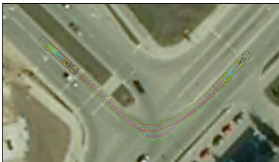
4.6 pav. 4 sankryžos pravažumo tyrimas (išvažiuojant iš SGGT)
