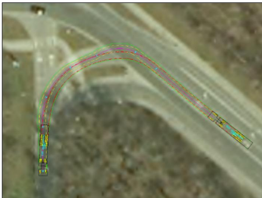
4.5 pav. 2 sankryžos pravažumo tyrimas (atvažiuojant į SGGT)
