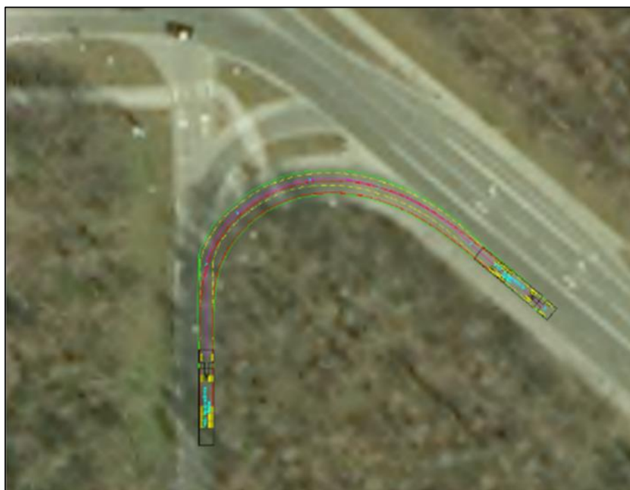
4.4 pav. 2 sankryžos pravažumo tyrimas (išvažiuojant iš SGGT)
