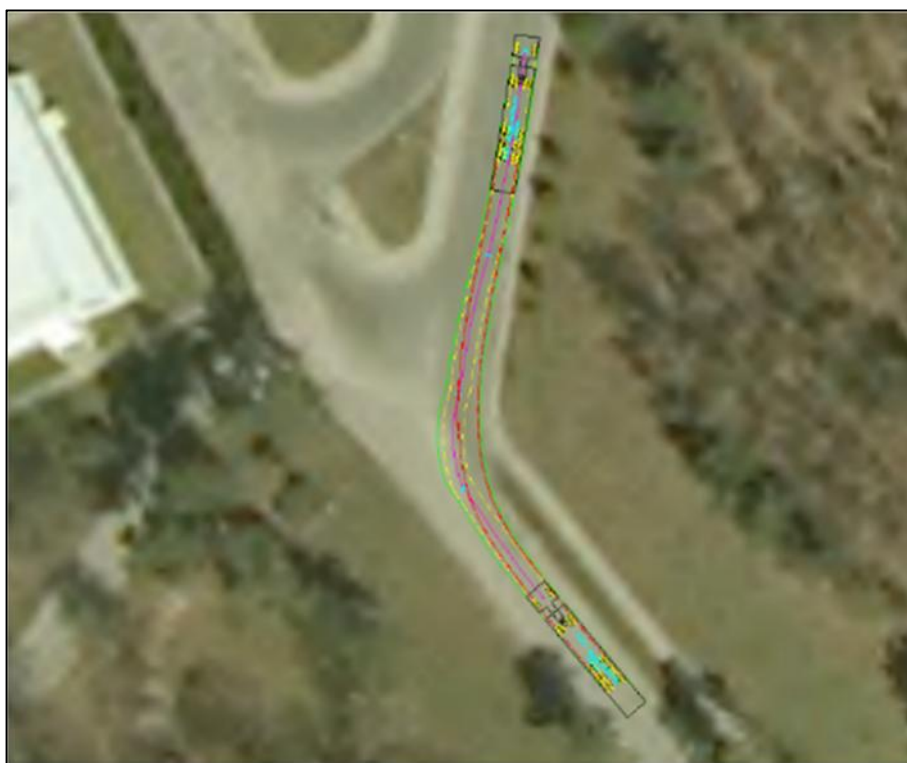
4.2 pav. 1 sankryžos pravažumo tyrimas (išvažiuojant iš SGGT)
